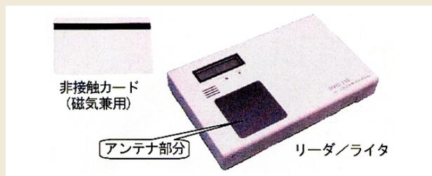
このカードは、無線タグ(tag: 付け札)、RFID (Radio Frequency-Identification) カード、無線カード、非接触カードなどと呼ばれています。なお、カードに内蔵された通信機能部分を指して、無線タグと呼ぶ場合もあります。通信媒体としては、電磁誘導や電波が使用されています。媒体の種類あるいは電波の周波数によって、通信距離や通信速度が異
