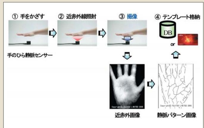
図-1 手のひら静脈認証の動作原理
