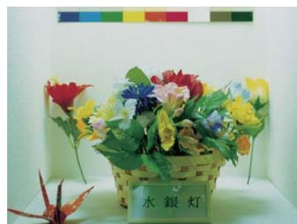
図-7 蛍光水銀ランプによる見え方
