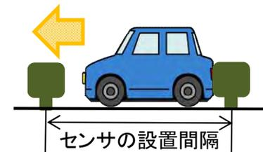
注1) センサを2台設置することにより、車両の進行方向を判別可能
